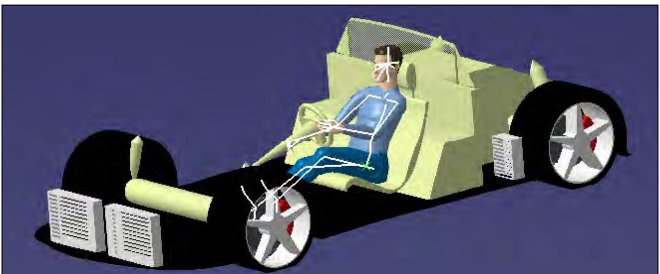
Figura 10: Layout fornito con aggiunta di pianale, cerchi, radiatori e lunotto interno.
