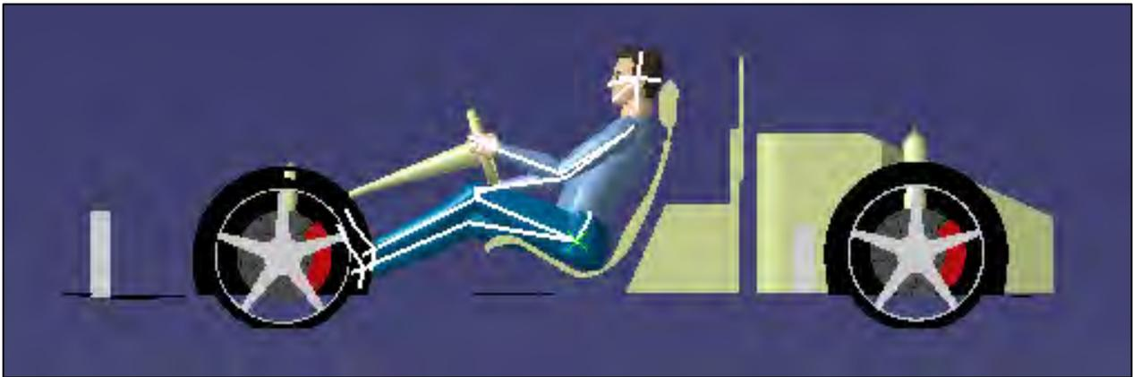
Figura 11: Layout fornito con aggiunta di pianale, cerchi, radiatori e lunotto interno.
