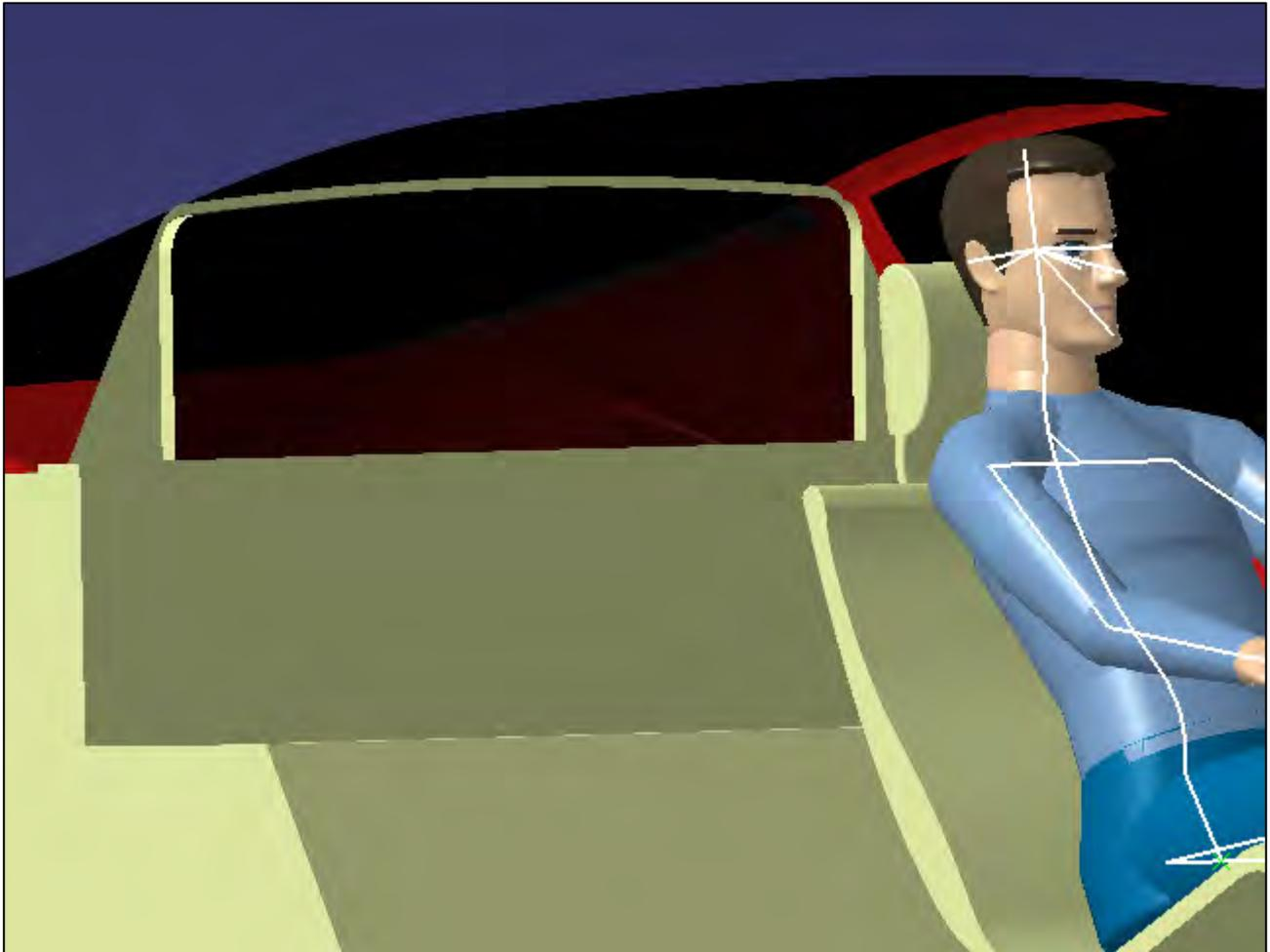
Figura 32: Lunotto interno di separazione.
