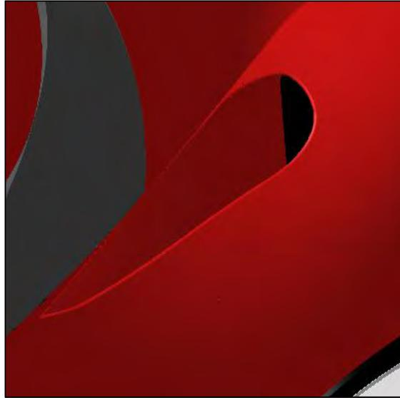
Figura 37: Presa d'aria su parafango posteriore.
